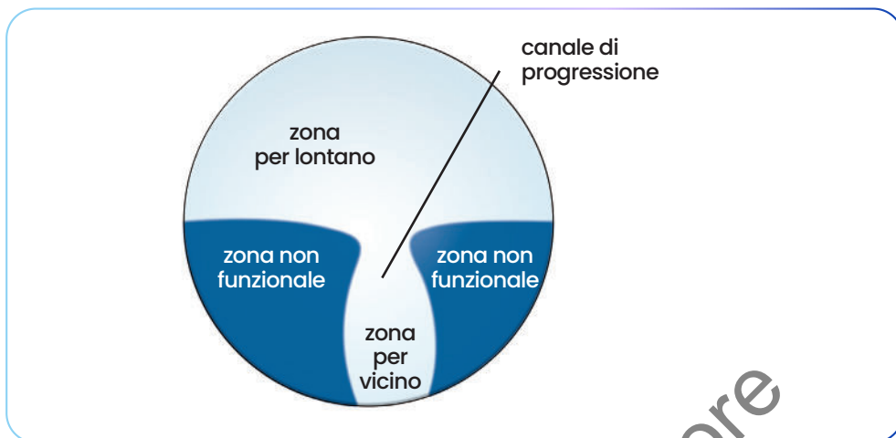
Figura 2.12 - Zone caratteristiche di una lente progressiva
